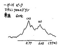
図3(b) ε-カプロラクタム(○)混合物 ナイロン6ダイマー(x)
