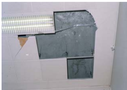
Fig. 2: 2 トン以上の耐荷重を有するベースプレートの爆発による破壊。
