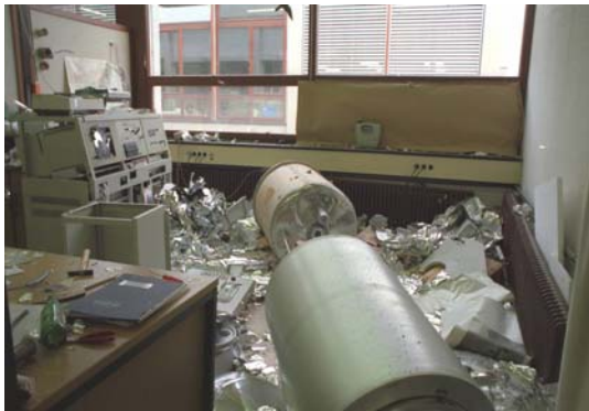
Fig. 1: 冷媒の閉塞による真空容器の爆発後の実験室
