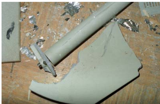
Fig. 2: 2 トン以上の耐荷重を有するベースプレートの爆発による破壊。
