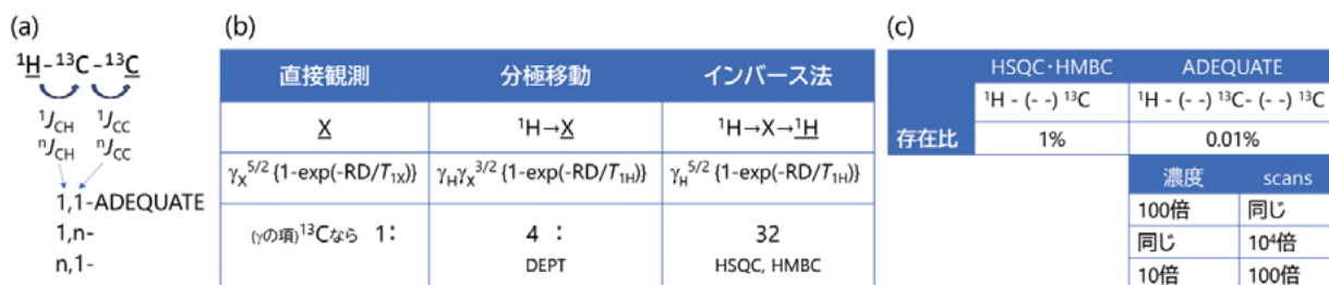
図48 (a) J_{CH} 、 J_{CC} を ^1J または ^nJ のどちらかに最適化するかによるADEQUATEの種類。(b) 磁化移動経路による感度の計算式。 \gamma_X 、 \gamma_H は核の磁気回転比。 \gamma_H / \gamma_C \approx 4 。異種核Xがカーボンの場合、 \{ \} の外の項は、インバース法は直接観測の32倍になる。(c) HSQCとADEQUATEの観測対象分子の存在割合と、試料濃度と積算回数の関係。
