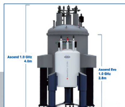
ENC 2024でリリースされたAscend Evo 600 (上) 従来型とAscend Evo 1.0GHzのサイズ比較 (下)
