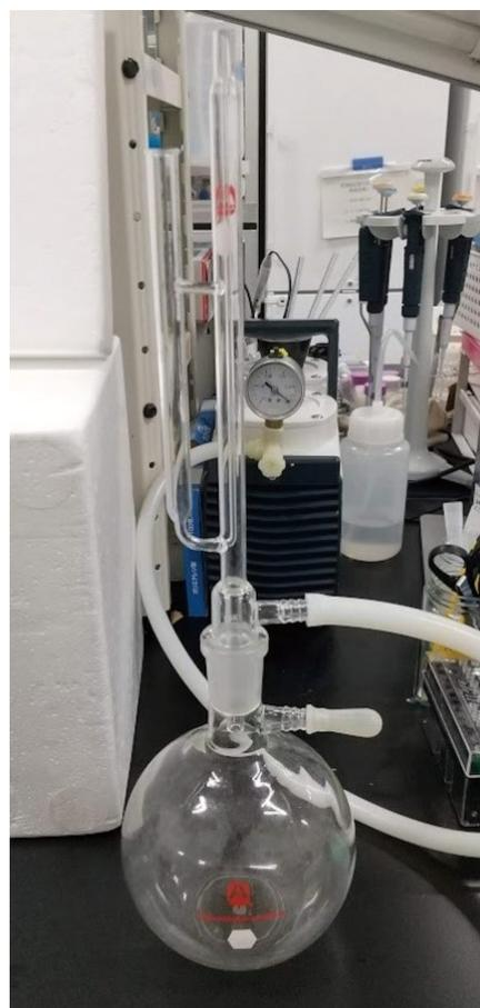
図5 サンプルチューブ洗浄用のガラス器具 (SIGMA製)。5mm管だけでなく、3mm管にも対応した器具が市販されています。
