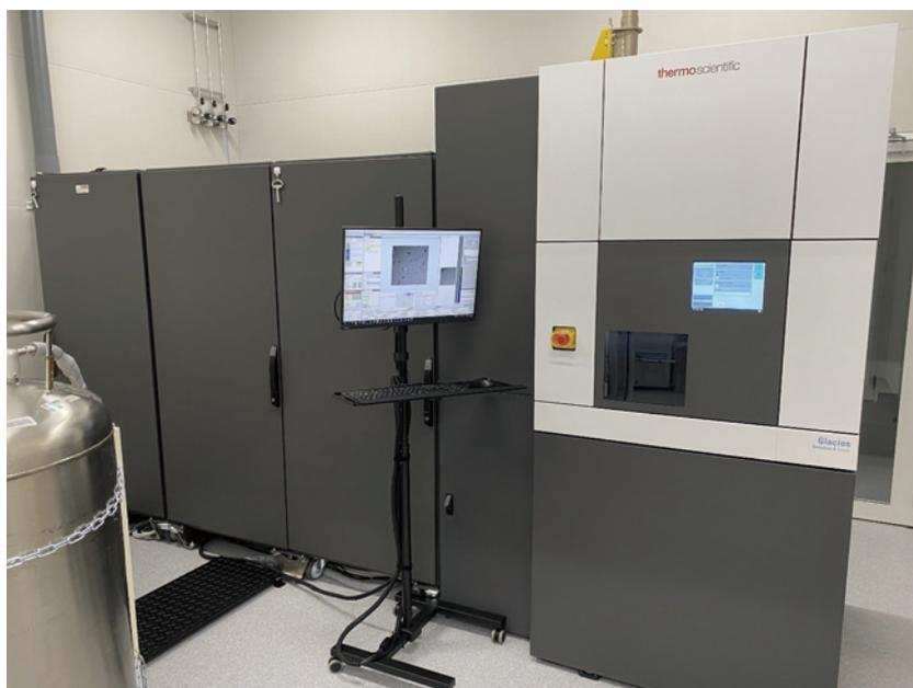
図3 社内に導入した加速電圧200kVのクライオ電子顕微鏡装置
