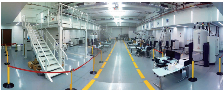
図2 KAUSTのNMR core Lab. (Bruker社製AVANCE III 950 MHzをはじめとする11台のNMR: 詳細は表1参照)
