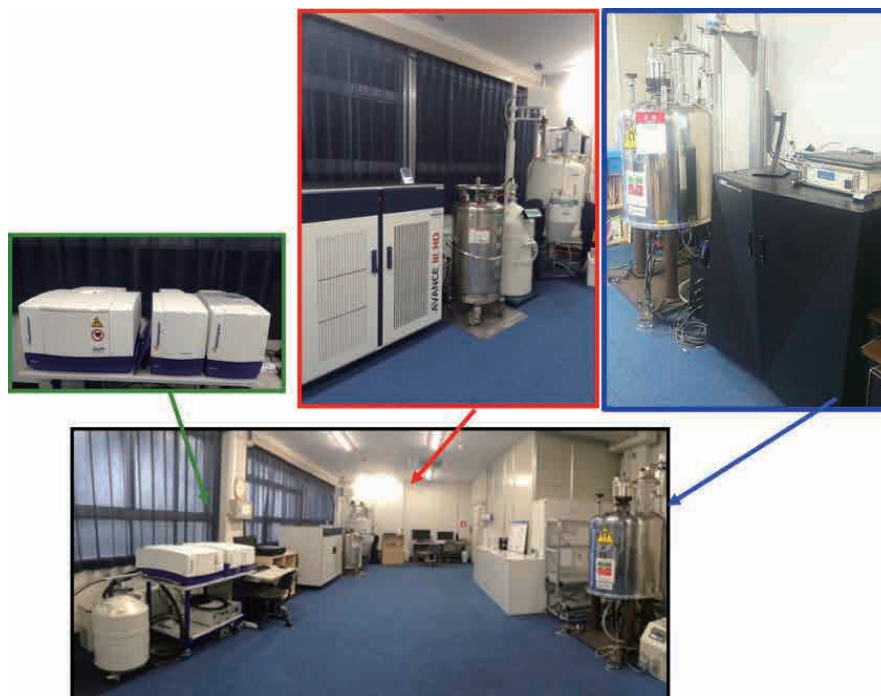
図2 NMR室の概観と保有装置。左からBruker製mini-spec、中央が高感度プローブ付きAVANCE III 溶液NMR、右がJEOL RESONANCE製ECZ400
