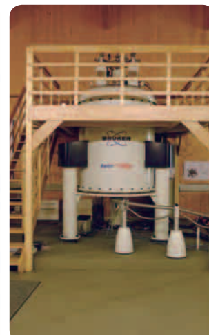
Fig. 1 パイロイト大学 (ドイツ) にインストールされたAeon 1GHz。 ドリフトレート ~ 1 Hz/hr (実績値)。写真は Prof. P. Röschより提供。
