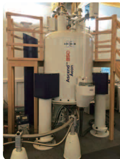
Fig. 4 リーズ大学 (イギリス) にインストールされた Ascend Aeon 950。ドリフトレート ~ 1Hz/hr (実績値)。 写真はProf. A. Breezeより提供
